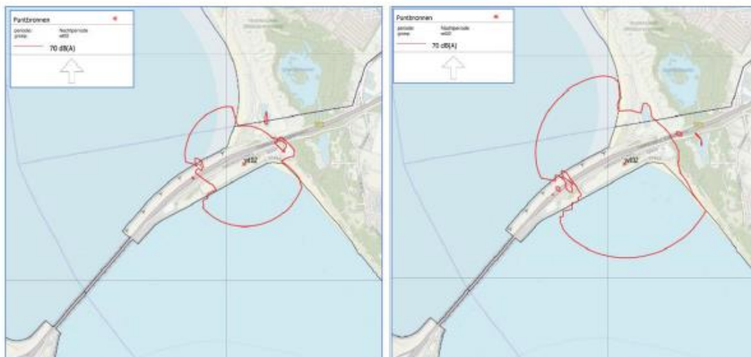
Afbeelding 5.2: Geluidcontouren voor het heien van funderingspalen van beton (links) en staal (rechts) voor windturbine (HVD2).
